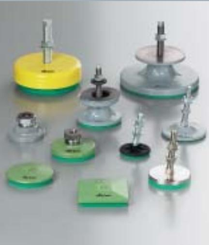
**PRG-Elemente** sind ausgelegt für eine einfache, wirtschaftliche und sichere Aufstellung Ihrer Maschine oder Anlage. Die patentierte Verbindung zwischen dem Element und der Nivellierschraube ist unlösbar, hoch belastbar und kann dennoch Bodenunebenheiten bis zu 4° selbstständig ausgleichen. Die verankerungsfreie Aufstellung und die einfache Nivellierung mit grossem Nivellierweg gewährleisten eine maximale Flexibilität Ihres Maschinenparks.
