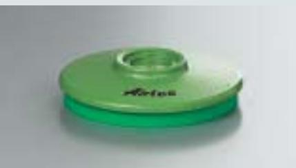
AirLoc bietet die weltweit grösste Auswahl von Nivellierschuhen an. Die grosse, ebene Auflagefläche sorgt für eine optimale Unterstützung des Maschinenbettes. Grosse Lasten bis zu 100 t pro Nivellierschuh können schnell und mit wenig Kraft auf  $\frac{1}{100}$  mm genau ausgerichtet werden. Die Einrichtzeit einer Maschine wird dadurch erheblich verkürzt.
