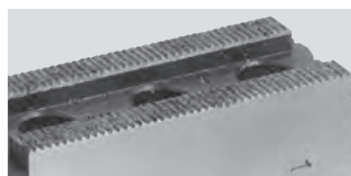
Verschmutzte / beschädigte Verzahnung
